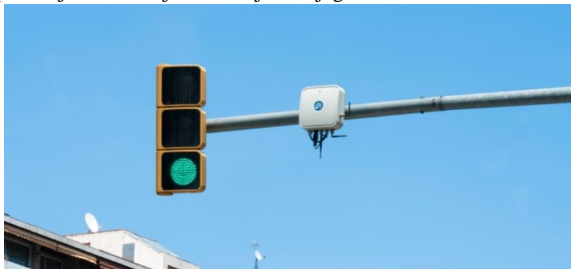
Senzor prioriteta prometa (izvor: smartcity.bcn.cat)
